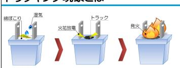
〇トラッキング現象はコンセントに差込んだプラグの周辺に綿ぼこり や湿気などが付着することにより、差込みプラグの刃の間に電流 が流れ、火花放電を繰り返すことで、絶縁樹脂表面に炭化導電路 (トラック)が形成され、発火する現象です。 火災発生の直接原因は「トラッキング現象」です。札幌市でも平成26年度にトラッキング現象が原因で発生した火災は判明しているだけで12件あります。また、短絡(ショート)が原因で22件、加熱が原因で14件、不明が20件で合計68件の電気に関連する火災がありました。
